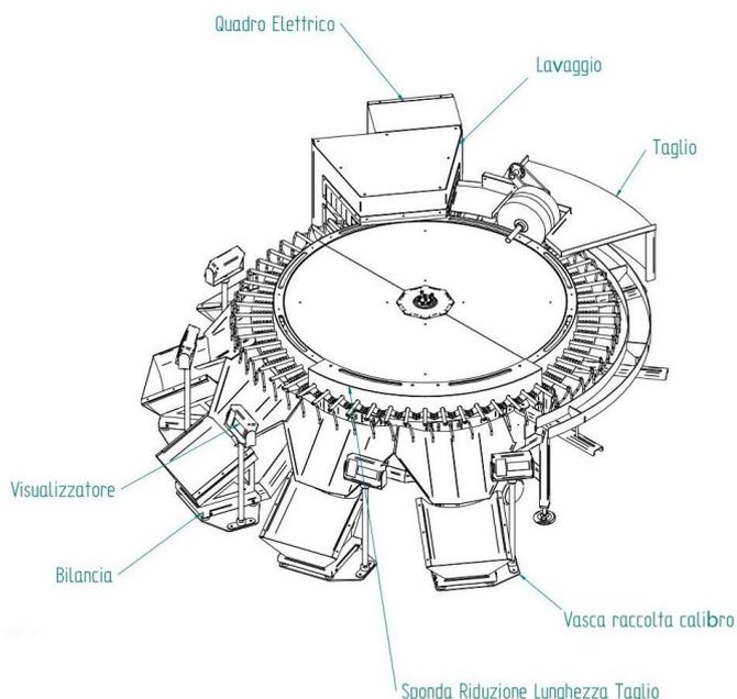
**Calibratura:** avviene tramite forchette speciali montate su una tavola rotante ( $\varnothing$  est. mm 2.200). L'apertura delle forchette, variabile in funzione dei diametri di calibratura desiderati, è operata da camme fisse a settore circolare in Delrin. Questo consente una calibratura molto precisa (per diametro), con 5 calibri. L'azionamento della tavola è diretto, tramite motoriduttore montato sull'albero centrale. Una frizione di sicurezza è incorporata nel motore.
